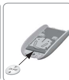
[4]. Remplacez la pile (3V CR 2430).
